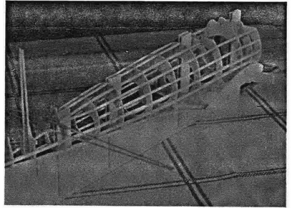
↑写真3 1/24スケールの零戦52型の胴体。フィレットと胴枠を一体にして製作している。
